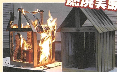
難燃木材の燃焼実験
