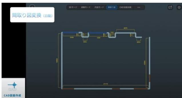
図5 寸法付きの平面図を自動作成、dxf 出力可
