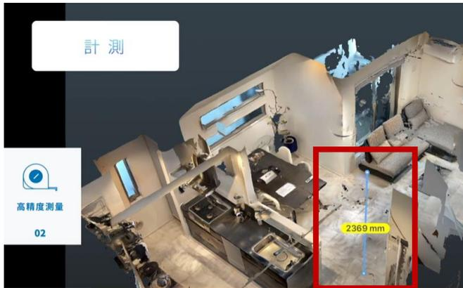
図3 2点をタップすることで距離計測が可能
