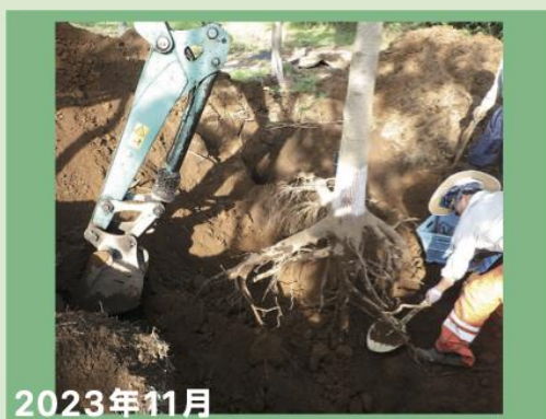
成蹊大学と共同研究。根まで掘り取りし、細断し、実験室で 固定炭素量測定。CO 2 吸収量推定。樹齢3年半のナリコー早生桐
